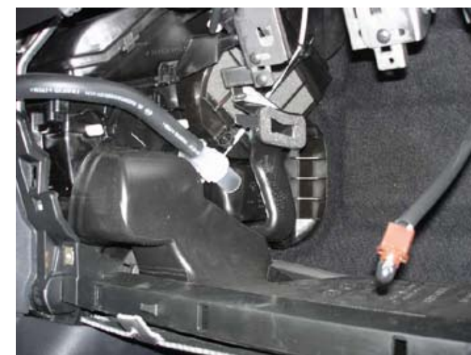
Здесь хорошо видно сопло подающее воздух в "бардачек"
