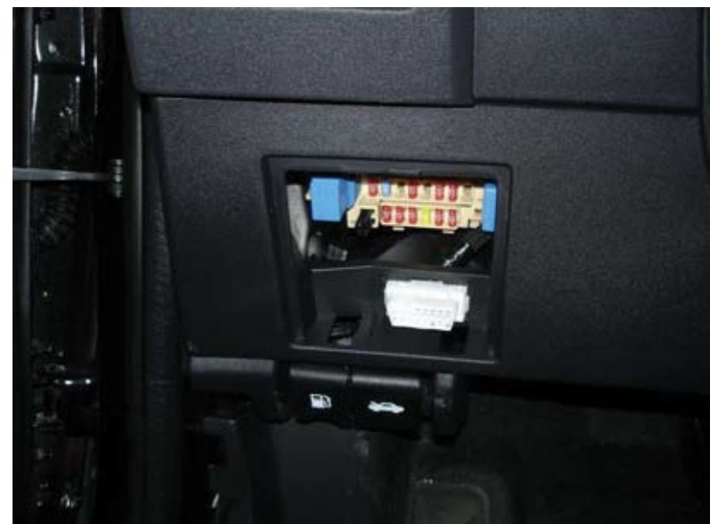
Тутачки живет разъем для подключения диагностики и предохранительный блок
