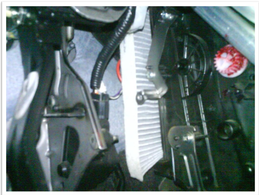
Фото 13. Установка салонного фильтра.
