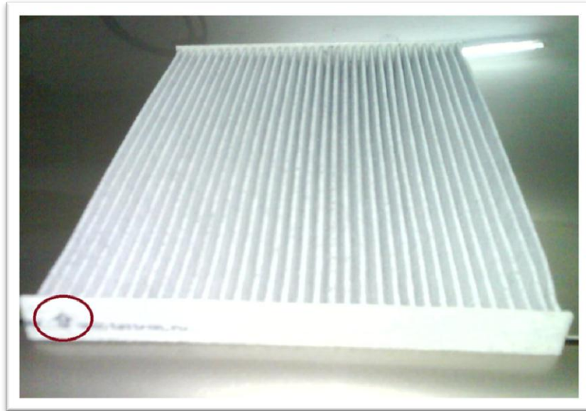
Фото 12. Направление потока воздуха на фильтре 9.7.372
