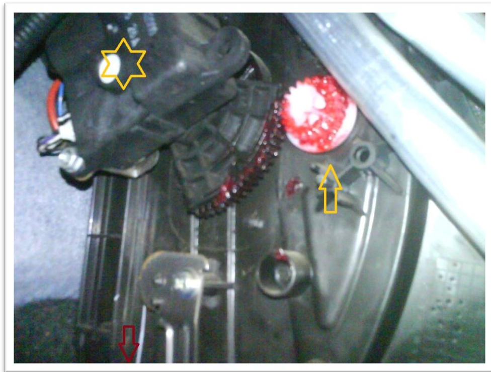
Фото 6. Снятие заглушки салонного фильтра.
