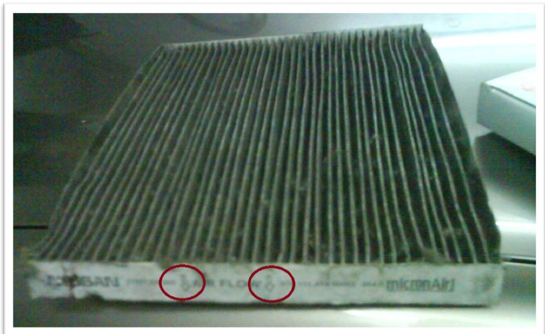
Фото 11. Направление потока воздуха на фильтре 27277-EN000
