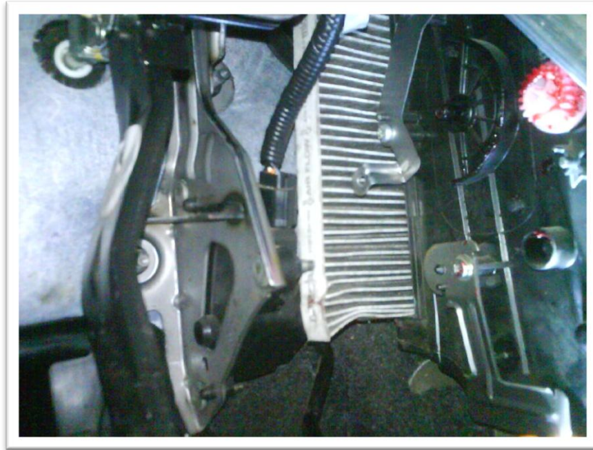
Фото 10. Извлечение салонного фильтра.
